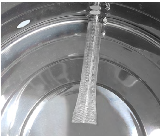
Korrekt montering af bazookafilter.
